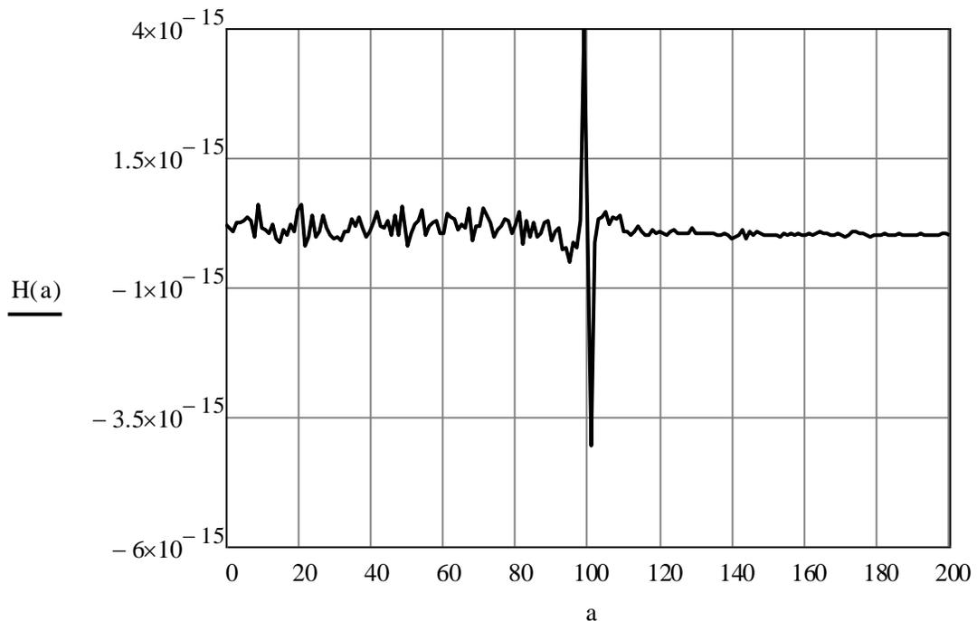
Точность расчета можно повысить, разбивая нить на большее число элементов. Точность аппроксимации ПЗП можно увеличить, увеличивая количество нитей тока. В данном случае, точность счета достаточна для того, чтобы полагать результат достоверным.
